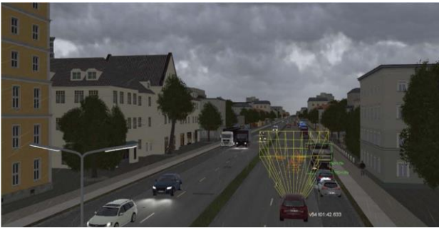
图 1. VIRES VTD 环境中的虚拟传感器模型
